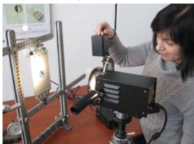
Obr.3 Analýza polí napätí odrazový polariskop LF/Z-2 Fig.3 Analysis of stress fields, reflection polariscope LF/Z-2
