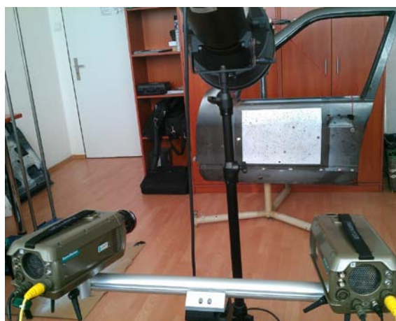
Obr.4 Vyšetřované predné dvere s vytvoreným čiernobielym vzorom, usporiadanie kamier a vysokovýkonného bodového zdroja bieleho svetla
