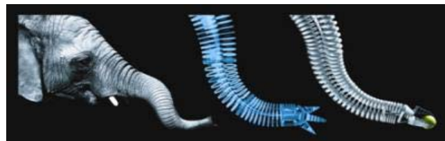
Obr.2 Porovnanie slonieho choboty a jeho hyper-redundantného znázornenia v podobe mechanizmu [7]
