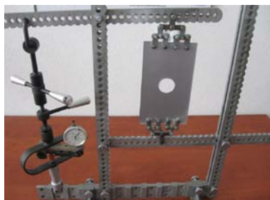
Obr.2 Zaťaženie dosky s kruhovým otvorom v strede Fig.2 Plate with a round hole under stress
