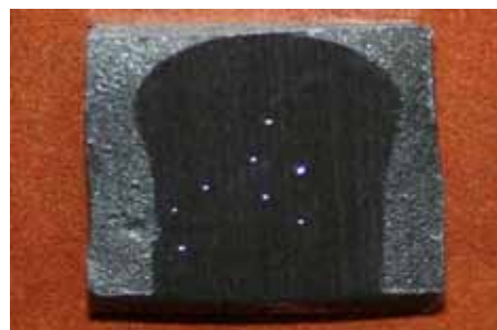
Obr.5 Meranie tvrdosti podľa Vickersa na vyšetřovanom objekte
