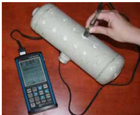
Obr.7 Merania hrúbky stien pomocou hrúbkomeru
