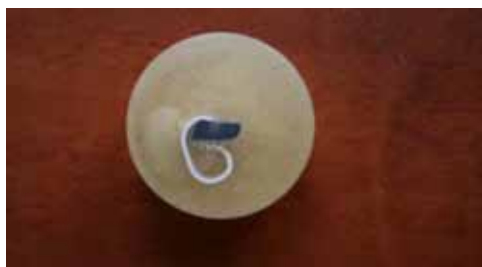
Obr.2 Vzorka zaliata do dentakrylu
