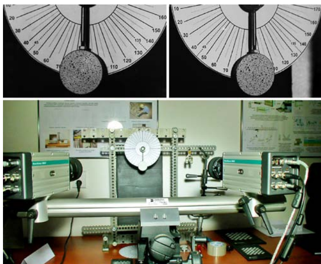
Obr.4 Usporiadanie kamier a pohľad z nich na meraný objekt
